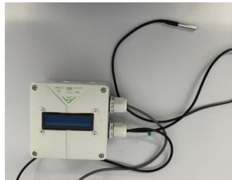
Misst zu Beginn die Anfangstemperaturen beider Platten (und der Rückseiten, wenn ihr möchtet) bevor ihr die Strahler anmacht. Verwendet hierfür die Werte der Messsensoren und verwendet auch einen Infrarot-Thermometer bzw. -kamera. Tragt die Werte in die Tabelle (nächste Seite) ein und schreibt eine Hypothese auf.
